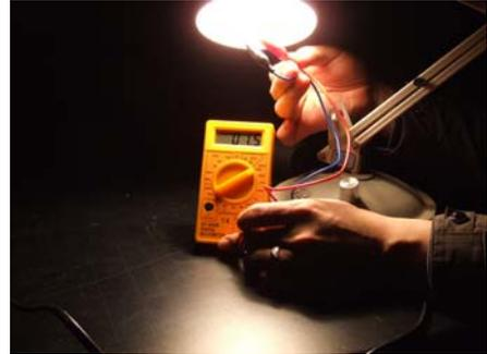
그림 2. 백열등의 광전류를 측정하는 모습. 측정치는 1.5 $\mu$ A이다
